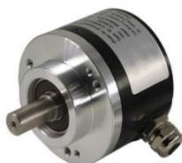
绝对式 WF58A10 多圈绝对值编码器，不锈钢轴，铝制外壳，密封结构，体积小，结构紧凑，具有良好的抗机械损伤性能，能够承受较高的轴向和径向负载，应用于角度、位移、距离、轨迹、倾斜测量和程控随动系统。WF58A10 多圈绝对值采用国际领先的齿轮组设计输出 SSI 信号，分辨率位数达 24 位。本产品具有欧盟 CE 出口认证，可出口欧盟各个国家。具有 ISO9001 质量管理体系认证。
